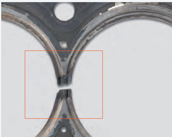
▲ Θραύση ράβδου που έχει προκληθεί εξαιτίας υψηλής δυναμικής εξαρτημάτων
