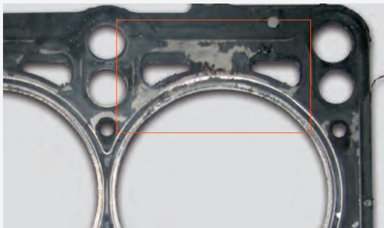
▲ Επίστρωση ελαστομερών που έχει υποστεί ζημιά εξαιτίας υπερθέρμανσης
